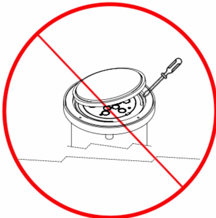
Ne pas utiliser d'outil pour faire levier sous peine d'endommager les composants et compromettre l'étanchéité
